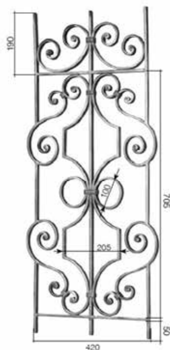
Art. 312A04 ∅14 x 8 mm H. 1000 mm L. 470 mm
