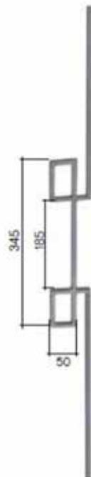
Art. 310A02 ∅14X8mm H.1000 mm L. 80 mm
