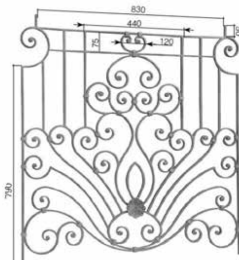
Art. 311A06 ∅14 x 8 mm H. 1000 mm L. 970 mm
